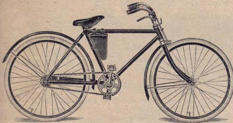
**Nr. 102. Knabenrad mit neutraler Marke**, in guter preiswerter geschweißter Ausführung. Rahmen ff. schwarz emailliert mit Doppellinien, prima Sattel, Tasche, Kette und Pedale, ff. vern. Lenker und Bremse, **holzfarbige Felgen**, Nova-Speichen, kompl. fahrbereit **m. Freilaufnabe Astoria, Centrix od. Mundus und Pneumatik Colonial rot**, lieferbar 24" Räder 40 cm hoch, 26" Räder 45 cm hoch,
