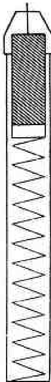
Рис. 11. Автоматический подаватель свечей.
