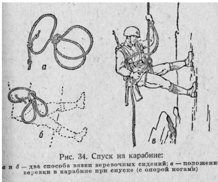
Рис.34. Спуск на карабине, а и б — два способа вязки веревочных сидений; в — положение веревки в карабине при спуске (с опорой ногами)
