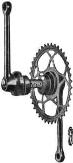
Ein großer Teil der damaligen Fahrräder ist mit sog. Glockentretlagern (s. Abb.) ausgerüstet. Anders als beim Keiltretlager, wo die Demontage in der Regel kein Problem darstellt, gestaltet sich die Arbeit am Glockenlager oft schwierig, da zum Ausbau bzw. zum Nachstellen die linke Kurbel gelöst werden muß. Lesen Sie hierzu bitte auch unseren **Werkstatt-Tipp**.
